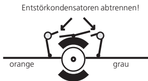
Abbildung 9: 5-poliger Märklin® Hochleistungsmotor
