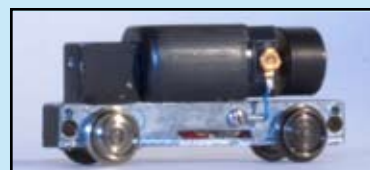
Färdigbyggt underrede för DC analogt utförande.
