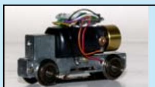
Färdigbyggt underrede för AC med dekoder.
